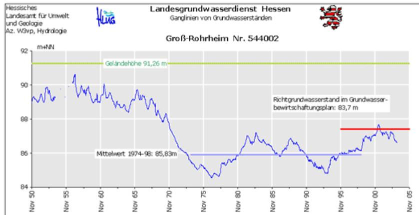
Abb.2: Durch Grundwasserentnahme beeinflusste Grundwasserstände, Messstelle Nr. 544002 Rohrheim, Zeitraum 1950-2003
